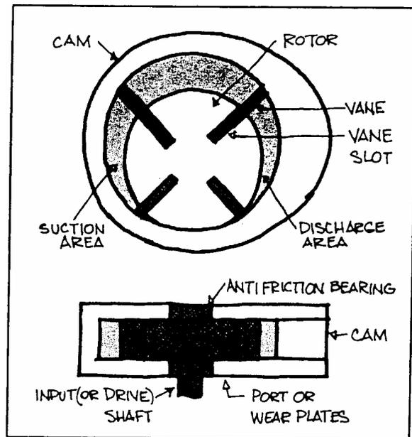
FIGURE 1- HYDRAULIC VANE PUMP
